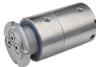
**Ejemplo de solución especial 3** – diseñada para una máquina de deposición en semiconductores. Con sellos mecánicos integrados para el servicio de agua, sellos de labios especiales para el servicio de aire y protección para evitar la contaminación de distintos fluidos.
